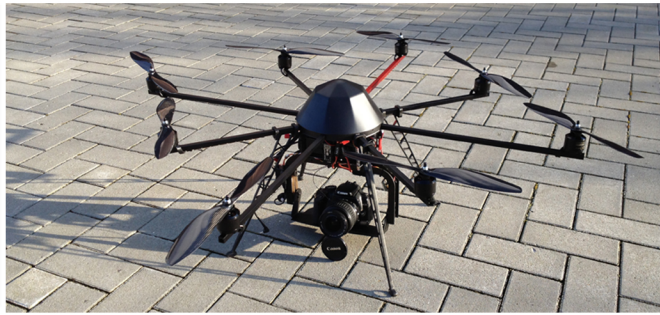
Der Octocopter wird eingesetzt, um Thermografieaufnahmen zu erstellen.
